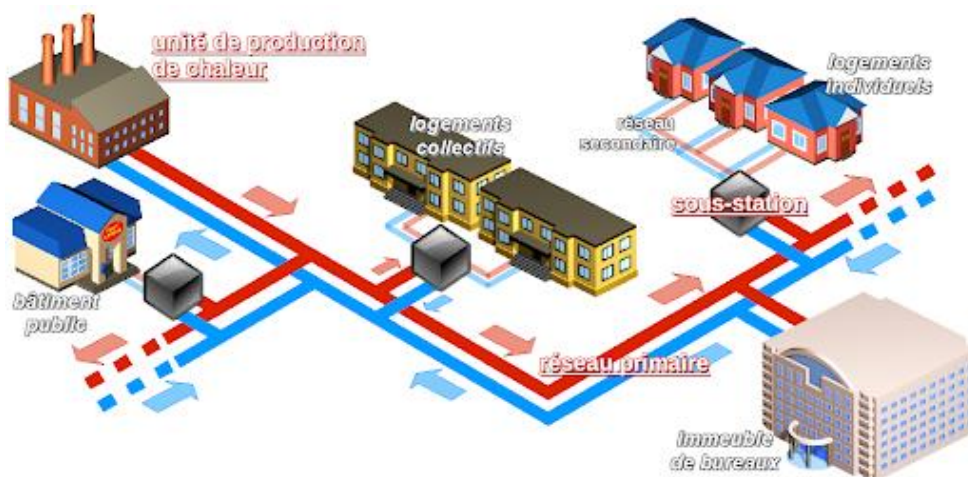
Figure 28 : Schéma d'un réseau de chaleur
