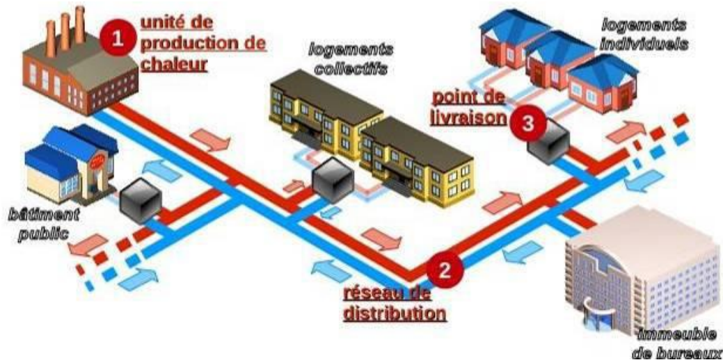
FIGURE 3: SCHEMA D'UN RESEAU DE CHALEUR
