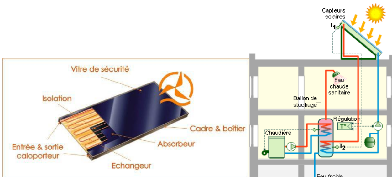
FIGURE 6: SCHEMAS DE FONCTIONNEMENT D'UN CAPTEUR ET D'UN CHAUFFE-EAU SOLAIRE
