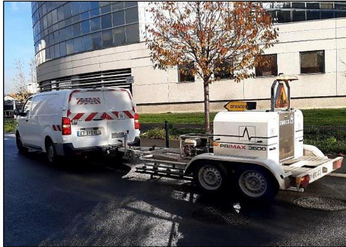
Figure 10 : Déflectomètre à masse tombante ou FWD
