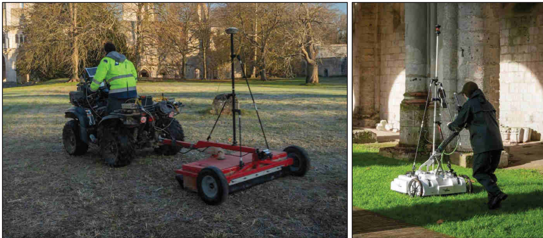
Figure 2 : photo du radar Raptor d'Impulse Radar, tracté à gauche et manuel à droite.
