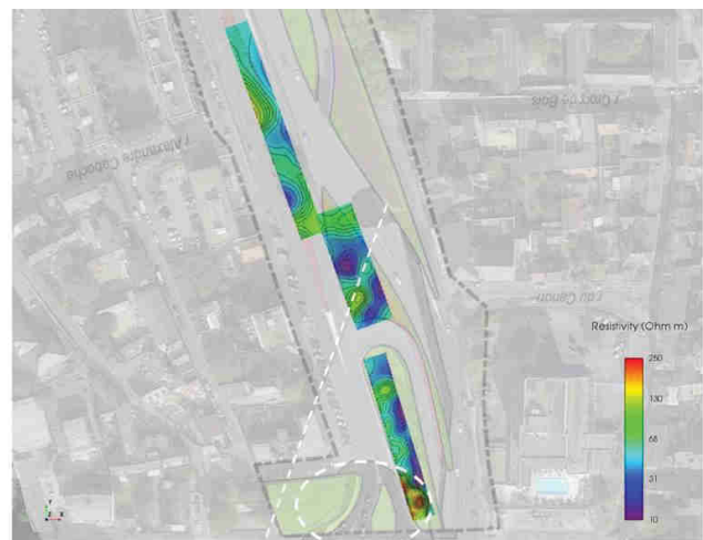
Figure 9 : Coupe horizontale à l'altitude de 95 mNGF.
