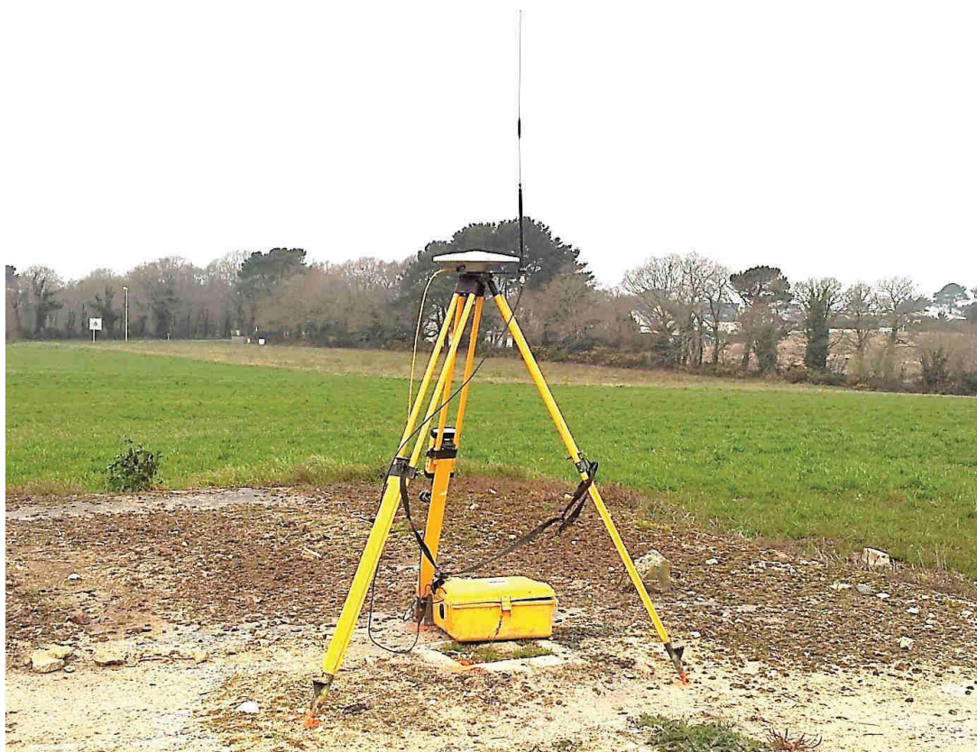
Figure 2 : Base GNSS RTK de la marque Trimble. Valise, trépied, mobile, antenne satellite et antenne radio.
