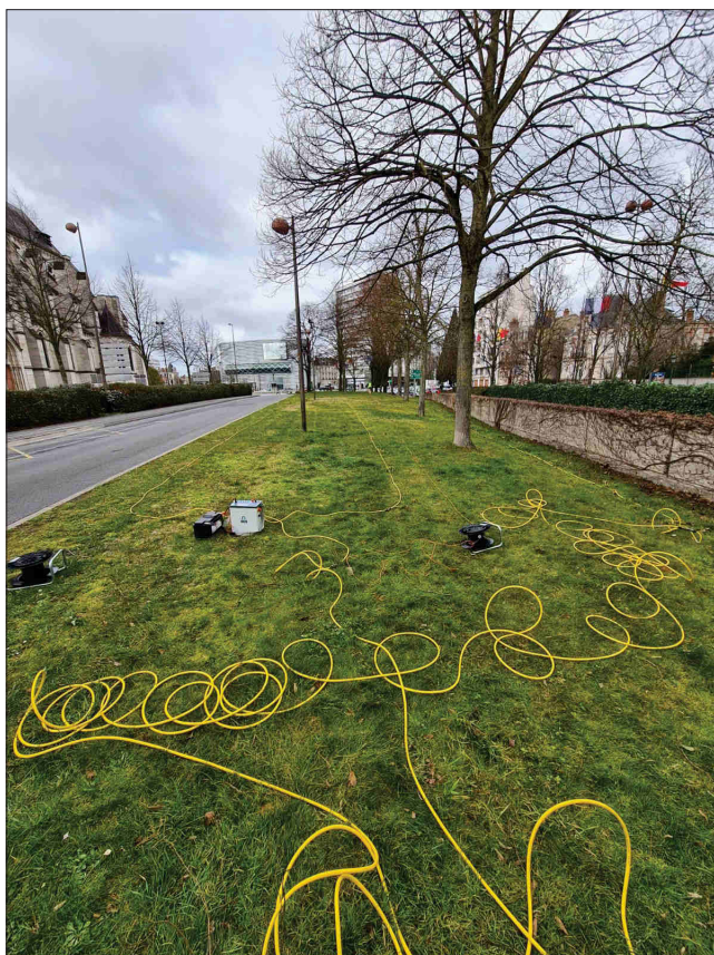
Fig. 22 : Disposition des câblages et de l'appareillage nécessaires pour la réalisation d'une tomographie par résistivité électrique (cliché : Alberto Rosselli, GEG Experts).
