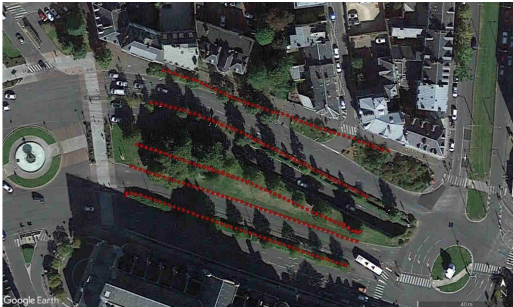
Figure 32 : Représentation des profils d'acquisitions – ERT 3D – Tronçon n°4.
