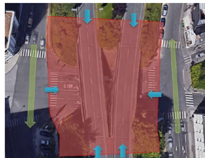
Implantation du chantier de démolition sur vue aérienne du Pont Saint Jean
