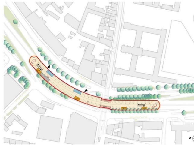
Figure 5 : Implantation du parking dans la trémie sous le pont Madeleine
