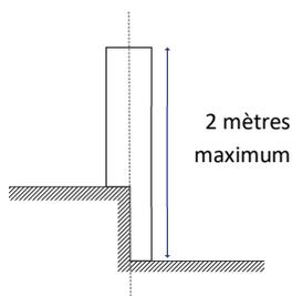
La clôture peut suivre la pente du terrain naturel. La hauteur est mesurée aux deux extrémités de la clôture.
