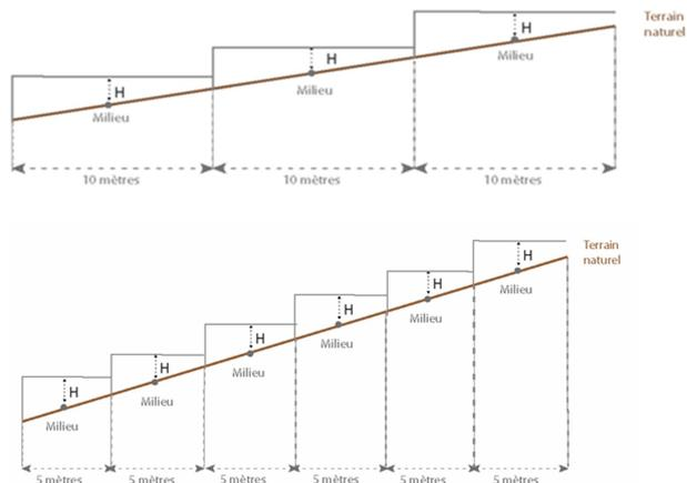
Dans le cas d'une clôture mitoyenne, la hauteur maximale autorisée est mesurée à partir du point le plus bas du terrain naturel.
