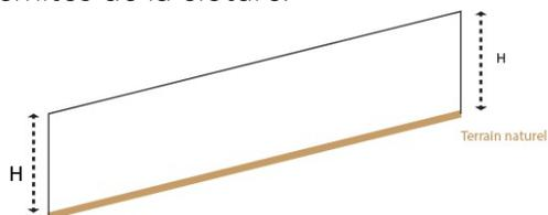
La hauteur de la clôture peut être découpée en sections de 5 à 10 mètres, à moduler selon l'importance de la pente et la longueur de la clôture. La hauteur est mesurée au milieu de chaque section.
